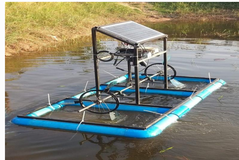
เครื่องเติมอากาศเพิ่มออกซิเจนพลังงานแสงอาทิตย์
